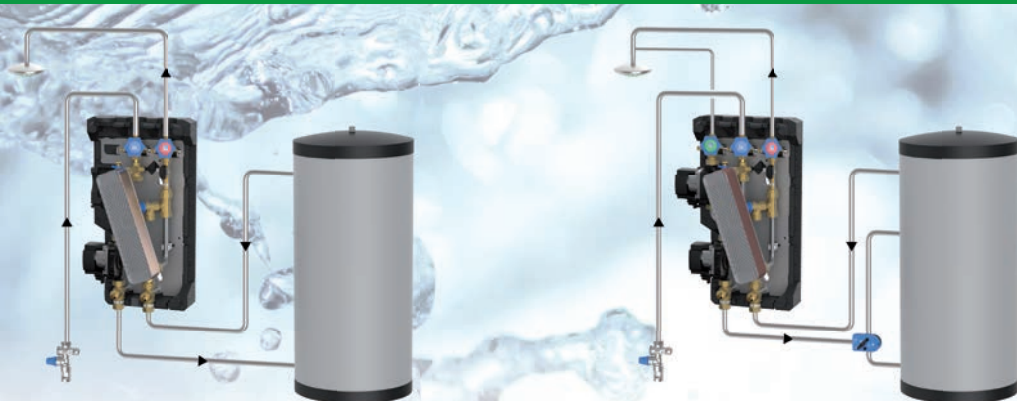
Montagebeispiel: FriwaMini mit Zirkulation, Rücklaufverteilungsset und Trinkwasserspeicher-Sicherheitsgruppe
